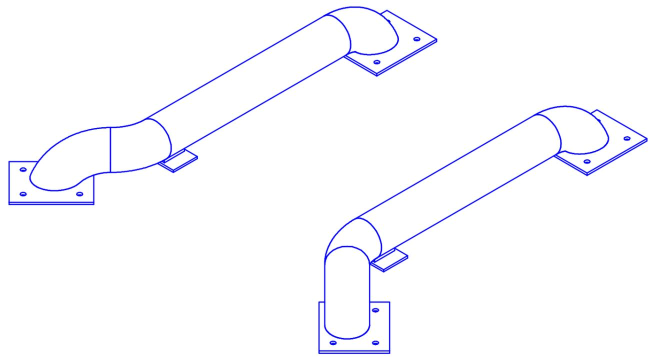
W - расстояние между направляющими, зависит от базы машины (2400-2600 мм) . Рекомендуемый зазор между колесом грузовика и направляющей для колес должен быть по 50 мм
